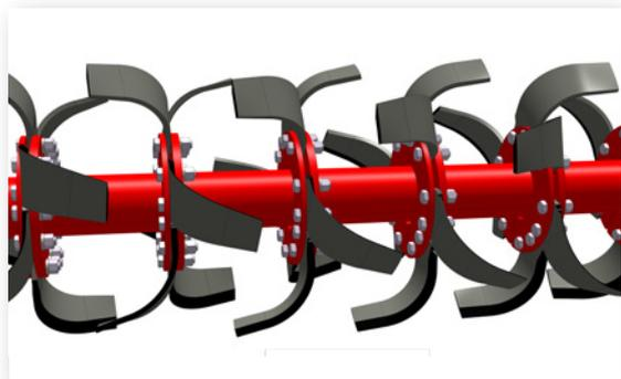
El rotor de azadas puede incorporar montados 2 tipos de azadas, en «C» y «L», capaces de maximizar el refinado del terreno y la incorporación del residuo de cultivo.
